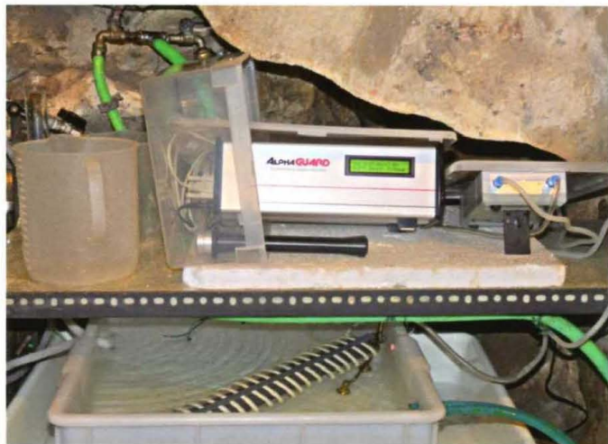
Complesso di misura del Radon nelle acque, nella vasca è contenuto lo speciale scambiatore acqua atmosfera.
